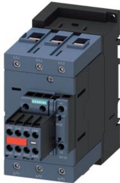
contattore di potenza, AC-3e/AC-3, 80 A, 37 kW / 400 V, a 3 poli, AC/DC 20...33 V, 50/60 Hz, con varistore integrato, contatti ausiliari: 2 NO + 2 NC, morsetti a vite, grandezza costruttiva: S3, blocchetto di contatti ausiliari non rimovibile
