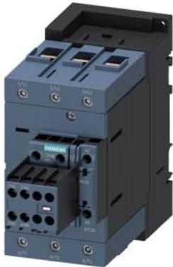
contattore di potenza, AC-3e/AC-3, 80 A, 37 kW / 400 V, a 3 poli, AC 24 V, 50 Hz, contatti ausiliari: 2 NO + 2 NC, morsetti a vite, grandezza costruttiva: S3, blocchetto di contatti ausiliari rimovibile
