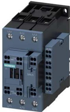
contattore di potenza, AC-3e/AC-3, 80 A, 37 kW / 400 V, a 3 poli, AC 230 V, 50 Hz, contatti ausiliari: 2 NO + 2 NC, circuito principale: morsetti a vite, circuito di comando e circuito ausiliario: morsetti a molla, grandezza costruttiva: S2, blocchetto di contatti ausiliari laterale
