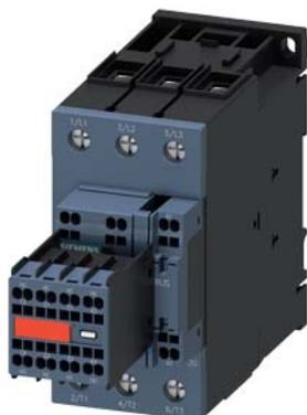
contattore di potenza, AC-3e/AC-3, 80 A, 37 kW / 400 V, a 3 poli, AC 110 V, 50 Hz / 120 V, 60 Hz, contatti ausiliari: 2 NO + 2 NC, circuito principale: morsetti a vite, circuito di comando e circuito ausiliario: morsetti a molla, grandezza costruttiva: S2, blocchetto di contatti ausiliari non rimovibile
