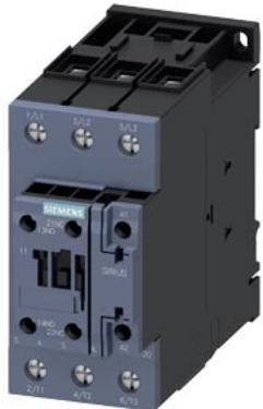
contattore di potenza, AC-3e/AC-3, 80 A, 37 kW / 400 V, a 3 poli, DC 24 V, 0,8...1,2\* US, con varistore integrato, contatti ausiliari: 1 NO + 1 NC, morsetti a vite, grandezza costruttiva: S2, adatto per uscite PLC
