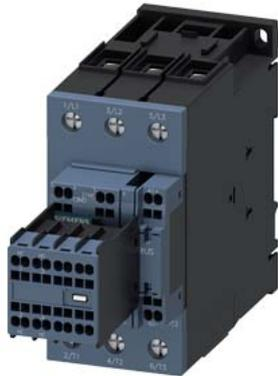
contattore ferroviario, AC-3e/AC-3, 65 A, 30 kW / 400 V, a 3 poli, DC 110 V, 0,7...1,25\* US, comando elettronico, con varistore integrato, contatti ausiliari: 2 NO + 2 NC, circuito principale: morsetti a vite, circuito di comando e circuito ausiliario: morsetti a molla, grandezza costruttiva: S2, blocchetto di contatti ausiliari rimovibile
