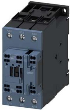
contattore di potenza, AC-3e/AC-3, 65 A, 30 kW / 400 V, a 3 poli, AC/DC 20...33 V, 50/60 Hz, con varistore integrato, contatti ausiliari: 1 NO + 1 NC, circuito principale: morsetti a vite, circuito di comando e circuito ausiliario: morsetti a molla, grandezza costruttiva: S2, con funzione di comunicazione
