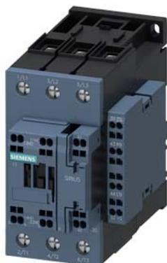
contattore di potenza, AC-3e/AC-3, 65 A, 30 kW / 400 V, a 3 poli, AC 230 V, 50 Hz, contatti ausiliari: 2 NO + 2 NC, circuito principale: morsetti a vite, circuito di comando e circuito ausiliario: morsetti a molla, grandezza costruttiva: S2, blocchetto di contatti ausiliari laterale
