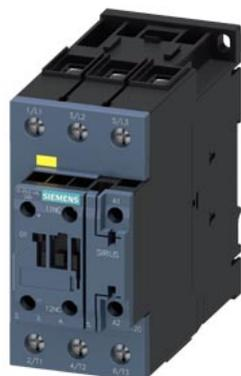
contattore di potenza, AC-3e/AC-3, 65 A, 30 kW / 400 V, a 3 poli, AC/DC 21...33 V, 50/60 Hz, con varistore integrato, contatti ausiliari: 1 NC, morsetti a vite, grandezza costruttiva: S2, F-PLC-IN
