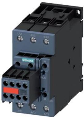
contattore di potenza, AC-3e/AC-3, 65 A, 30 kW / 400 V, a 3 poli, DC 24 V, 0,8...1,2\* US, con varistore integrato, contatti ausiliari: 2 NO + 2 NC, morsetti a vite, grandezza costruttiva: S2, blocchetto di contatti ausiliari non rimovibile, adatto per uscite PLC
