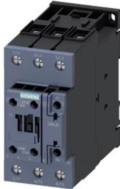
contattore di potenza, AC-3e/AC-3, 65 A, 30 kW / 400 V, a 3 poli, DC 24 V, 0,8...1,2\* US, con varistore integrato, contatti ausiliari: 1 NO + 1 NC, morsetti a vite, grandezza costruttiva: S2, adatto per uscite PLC
