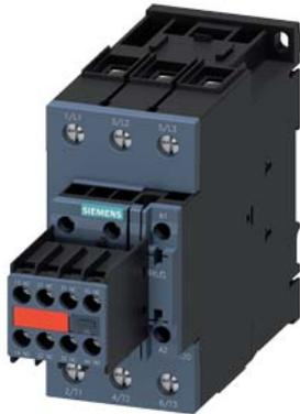
contattore di potenza, AC-3e/AC-3, 65 A, 30 kW / 400 V, a 3 poli, AC 110 V, 50 Hz / 120 V, 60 Hz, con varistore innestato, contatti ausiliari: 2 NO + 2 NC, morsetti a vite, grandezza costruttiva: S2, blocchetto di contatti ausiliari non rimovibile
