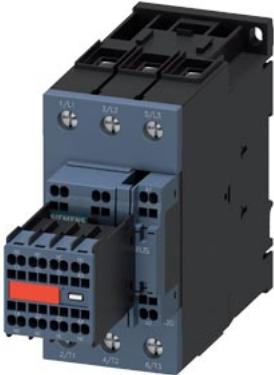
contattore di potenza, AC-3e/AC-3, 51 A, 22 kW / 400 V, a 3 poli, AC/DC 20...33 V, 50/60 Hz, con varistore integrato, contatti ausiliari: 2 NO + 2 NC, circuito principale: morsetti a vite, circuito di comando e circuito ausiliario: morsetti a molla, grandezza costruttiva: S2, blocchetto di contatti ausiliari non rimovibile
