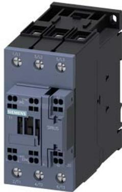
contattore di potenza, AC-3e/AC-3, 51 A, 22 kW / 400 V, a 3 poli, AC 230 V, 50/60 Hz, con gruppo RC inserito, contatti ausiliari: 1 NO + 1 NC, circuito principale: morsetti a vite, circuito di comando e circuito ausiliario: morsetti a molla, grandezza costruttiva: S2,
