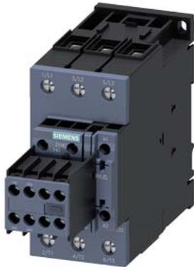
contattore di potenza, AC-3e/AC-3, 51 A, 22 kW / 400 V, a 3 poli, AC 230 V, 50 Hz, con varistore innestato, contatti ausiliari: 2 NO + 2 NC, morsetti a vite, grandezza costruttiva: S2, blocchetto di contatti ausiliari rimovibile
