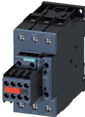
contattore di potenza, AC-3e/AC-3, 51 A, 22 kW / 400 V, a 3 poli, AC 110 V, 50 Hz / 120 V, 60 Hz, contatti ausiliari: 2 NO + 2 NC, morsetti a vite, grandezza costruttiva: S2, blocchetto di contatti ausiliari non rimovibile
