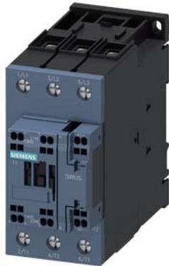
contattore ferroviario, AC-3e/AC-3, 41 A, 18,5 kW / 400 V, a 3 poli, DC 110 V, 0,7...1,25\* US, comando elettronico, con varistore integrato, contatti ausiliari: 1 NO + 1 NC, circuito principale: morsetti a vite, circuito di comando e circuito ausiliario: morsetti a molla, grandezza costruttiva: S2
