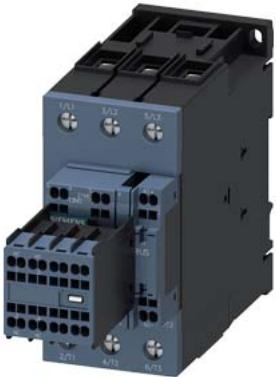
contattore ferroviario, AC-3e/AC-3, 41 A, 18,5 kW / 400 V, a 3 poli, DC 24 V, 0,7...1,25\* US, comando elettronico, con varistore integrato, contatti ausiliari: 2 NO + 2 NC, circuito principale: morsetti a vite, circuito di comando e circuito ausiliario: morsetti a molla, grandezza costruttiva: S2, blocchetto di contatti ausiliari rimovibile
