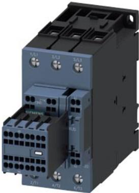
contattore di potenza, AC-3e/AC-3, 41 A, 18,5 kW / 400 V, a 3 poli, AC/DC 48...80 V, 50/60 Hz, con varistore integrato, contatti ausiliari: 2 NO + 2 NC, circuito principale: morsetti a vite, circuito di comando e circuito ausiliario: morsetti a molla, grandezza costruttiva: S2, blocchetto di contatti ausiliari rimovibile
