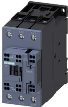
contattore di potenza, AC-3e/AC-3, 41 A, 18,5 kW / 400 V, a 3 poli, AC 100 V, 50 Hz / 100...110 V, 60 Hz, contatti ausiliari: 1 NO + 1 NC, circuito principale: morsetti a vite, circuito di comando e circuito ausiliario: morsetti a molla, grandezza costruttiva: S2,
