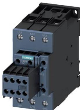
contattore di potenza, AC-3e/AC-3, 41 A, 18,5 kW / 400 V, a 3 poli, AC/DC 83...155 V, 50/60 Hz, con varistore integrato, contatti ausiliari: 2 NO + 2 NC, morsetti a vite, grandezza costruttiva: S2, blocchetto di contatti ausiliari rimovibile
