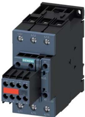
contattore di potenza, AC-3e/AC-3, 41 A, 18,5 kW / 400 V, a 3 poli, AC 230 V, 50/60 Hz, con varistore innestato, contatti ausiliari: 2 NO + 2 NC, morsetti a vite, grandezza costruttiva: S2, blocchetto di contatti ausiliari non rimovibile
