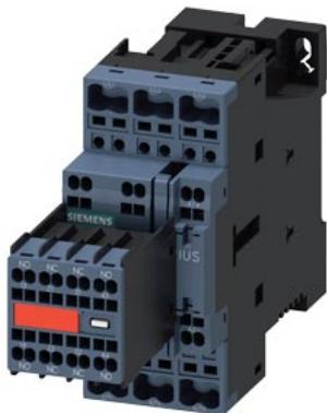
contattore di potenza, AC-3e/AC-3, 38 A, 18,5 kW / 400 V, a 3 poli, DC 24 V, contatti ausiliari: 2 NO + 2 NC, morsetti a molla, grandezza costruttiva: S0, blocchetto di contatti ausiliari non rimovibile, senza limitatore di sovratensione retrofittabile
