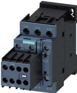
contattore di potenza, AC-3e/AC-3, 32 A, 15 kW / 400 V, a 3 poli, AC 110 V, 50 Hz, contatti ausiliari: 2 NO + 2 NC, morsetti a vite, grandezza costruttiva: S0, blocchetto di contatti ausiliari rimovibile
