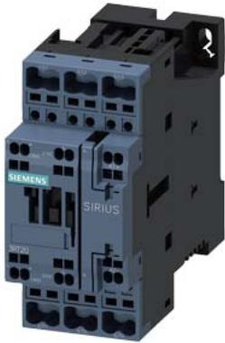
contattore di potenza, AC-3e/AC-3, 25 A, 11 kW / 400 V, a 3 poli, AC/DC 200...280 V, 50/60 Hz, con varistore integrato, contatti ausiliari: 1 NO + 1 NC, morsetti a molla, grandezza costruttiva: S0
