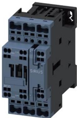
contattore di potenza, AC-3e/AC-3, 25 A, 11 kW / 400 V, a 3 poli, AC 480 V, 60 Hz, con varistore innestato, contatti ausiliari: 1 NO + 1 NC, morsetti a molla, grandezza costruttiva: S0
