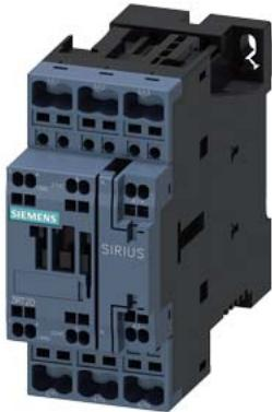
contattore di potenza, AC-3e/AC-3, 25 A, 11 kW / 400 V, a 3 poli, DC 48 V, contatti ausiliari: 1 NO + 1 NC, morsetti a molla, grandezza costruttiva: S0
