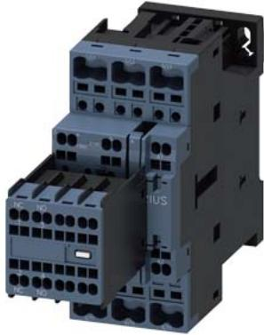
contattore di potenza, AC-3e/AC-3, 25 A, 11 kW / 400 V, a 3 poli, AC 110 V, 50/60 Hz, contatti ausiliari: 2 NO + 2 NC, morsetti a molla, grandezza costruttiva: S0, blocchetto di contatti ausiliari rimovibile
