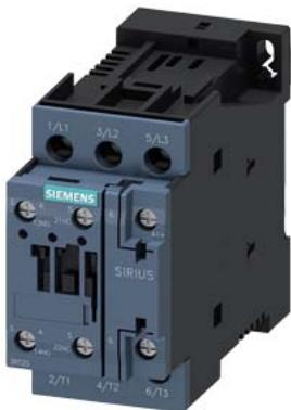
contattore di potenza, AC-3e/AC-3, 25 A, 11 kW / 400 V, a 3 poli, DC 24 V, contatti ausiliari: 1 NO + 1 NC, morsetti a vite, grandezza costruttiva: S0, con funzione di comunicazione
