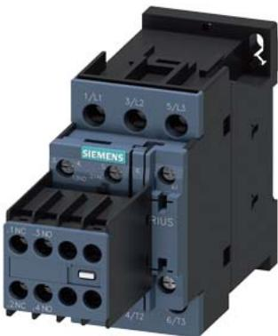
contattore di potenza, AC-3e/AC-3, 25 A, 11 kW / 400 V, a 3 poli, AC 110 V, 50 Hz / 120 V, 60 Hz, contatti ausiliari: 2 NO + 2 NC, morsetti a vite, grandezza costruttiva: S0, blocchetto di contatti ausiliari rimovibile
