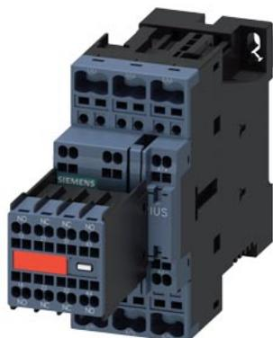
contattore di potenza, AC-3e/AC-3, 17 A, 7,5 kW / 400 V, a 3 poli, DC 24 V, con varistore innestato, contatti ausiliari: 2 NO + 2 NC, morsetti a molla, grandezza costruttiva: S0, blocchetto di contatti ausiliari non rimovibile
