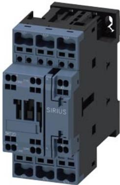
contattore di potenza, AC-3e/AC-3, 17 A, 7,5 kW / 400 V, a 3 poli, AC 230 V, 50 Hz, contatti ausiliari: 1 NO + 1 NC, morsetti a molla, grandezza costruttiva: S0, posizione di montaggio verticale
