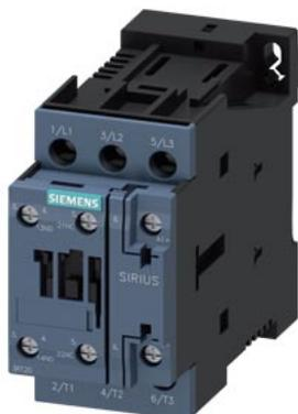
contattore ferroviario, AC-3e/AC-3, 17 A, 7,5 kW / 400 V, a 3 poli, DC 110 V, 0,7...1,25\* US, comando elettronico, con varistore integrato, contatti ausiliari: 1 NO + 1 NC, morsetti a vite, grandezza costruttiva: S0
