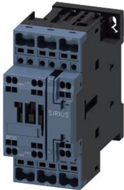
contattore di potenza, AC-3e/AC-3, 12 A, 5,5 kW / 400 V, a 3 poli, AC 48 V, 50 Hz, contatti ausiliari: 1 NO + 1 NC, morsetti a molla, grandezza costruttiva: S0
