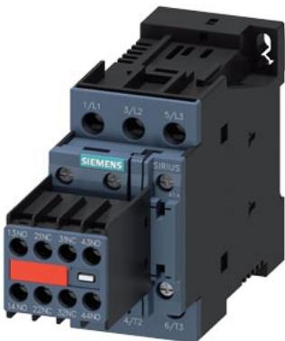
contattore di potenza, AC-3e/AC-3, 12 A, 5,5 kW / 400 V, a 3 poli, DC 24 V, con (inserita) combinazione di diodi, contatti ausiliari: 2 NO + 2 NC, morsetti a vite, grandezza costruttiva: S0, blocchetto di contatti ausiliari non rimovibile, posizione di montaggio verticale
