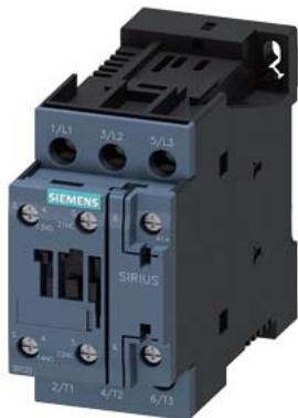
contattore di potenza, AC-3e/AC-3, 12 A, 5,5 kW / 400 V, a 3 poli, DC 48 V, contatti ausiliari: 1 NO + 1 NC, morsetti a vite, grandezza costruttiva: S0
