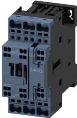
contattore di potenza, AC-3e/AC-3, 9 A, 4 kW / 400 V, a 3 poli, AC 400 V, 50 Hz, contatti ausiliari: 1 NO + 1 NC, morsetti a molla, grandezza costruttiva: S0
