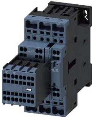
contattore di potenza, AC-3e/AC-3, 9 A, 4 kW / 400 V, a 3 poli, AC 24 V, 50 Hz, contatti ausiliari: 2 NO + 2 NC, morsetti a molla, grandezza costruttiva: S0, blocchetto di contatti ausiliari rimovibile
