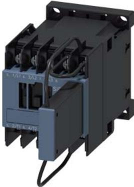
contattore ferroviario, AC-3e/AC-3, 16 A, 7,5 kW / 400 V, a 3 poli, DC 24 V, 0,7...1,25\* US, con varistore integrato, contatti ausiliari: 1 NC, collegamento con capocorda ad occhiello, grandezza costruttiva: S00, con (innestata) resistenza addizionale
