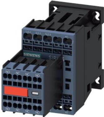
contattore di potenza, AC-3e/AC-3, 16 A, 7,5 kW / 400 V, a 3 poli, DC 24 V, contatti ausiliari: 2 NO + 2 NC, morsetti a molla, grandezza costruttiva: S00, blocchetto di contatti ausiliari non rimovibile
