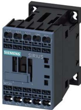
contattore di potenza, AC-3e/AC-3, 16 A, 7,5 kW / 400 V, a 3 poli, DC 12 V, contatti ausiliari: 1 NO, morsetti a molla, grandezza costruttiva: S00
