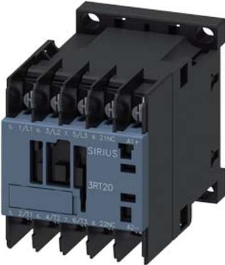
contattore di potenza, AC-3e/AC-3, 12 A, 5,5 kW / 400 V, a 3 poli, DC 24 V, 0,7...1,25\* US, con (integrato) diodo soppressore, contatti ausiliari: 1 NC, collegamento con capocorda ad occhiello, grandezza costruttiva: S00, adatto per uscite PLC, non ampliabile con blocchetto di contatti ausiliari
