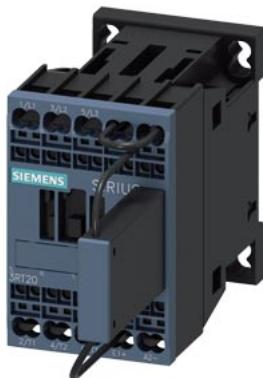
contattore ferroviario, AC-3e/AC-3, 12 A, 5,5 kW / 400 V, a 3 poli, DC 24 V, 0,7...1,25\* US, con (integrato) diodo sottile, contatti ausiliari: 1 NC, morsetti a molla, grandezza costruttiva: S00, adatto per uscite PLC, non ampliabile con blocchetto di contatti ausiliari , posizione di montaggio verticale
