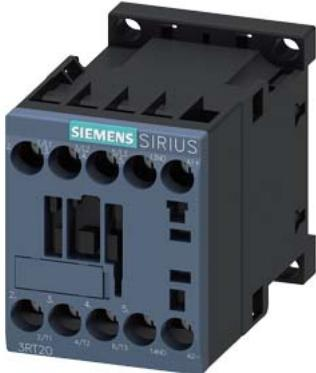
contattore di potenza, AC-3e/AC-3, 12 A, 5,5 kW / 400 V, a 3 poli, DC 24 V, con varistore integrato, contatti ausiliari: 1 NO, morsetti a vite, grandezza costruttiva: S00
