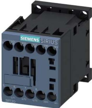
contattore di potenza, AC-3e/AC-3, 12 A, 5,5 kW / 400 V, a 3 poli, DC 24 V, 0,7...1,25\* US, con (integrato) diodo soppressore, contatti ausiliari: 1 NC, morsetti a vite, grandezza costruttiva: S00, adatto per uscite PLC, non ampliabile con blocchetto di contatti ausiliari
