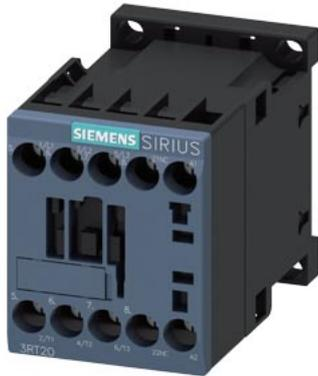
contattore di potenza, AC-3e/AC-3, 12 A, 5,5 kW / 400 V, a 3 poli, AC 230 V, 50/60 Hz, contatti ausiliari: 1 NC, morsetti a vite, grandezza costruttiva: S00, posizione di montaggio sospesa
