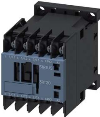
contattore di potenza, AC-3e/AC-3, 9 A, 4 kW / 400 V, a 3 poli, AC 230 V, 50/60 Hz, contatti ausiliari: 1 NO, collegamento con capocorda ad occhiello, grandezza costruttiva: S00
