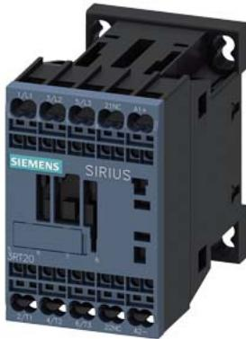
contattore di potenza, AC-3e/AC-3, 9 A, 4 kW / 400 V, a 3 poli, DC 24 V, 0,85...1,85\* US, con (integrato) diodo sottile, contatti ausiliari: 1 NC, morsetti a molla, grandezza costruttiva: S00
