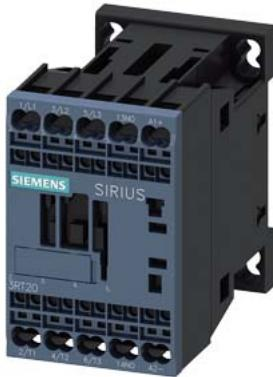
contattore di potenza, AC-3e/AC-3, 9 A, 4 kW / 400 V, a 3 poli, DC 24 V, contatti ausiliari: 1 NO, morsetti a molla, grandezza costruttiva: S00, posizione di montaggio verticale
