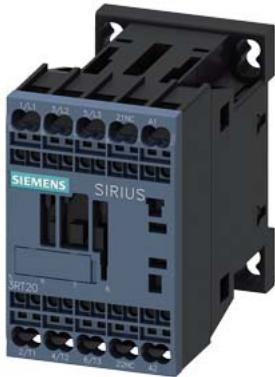
contattore di potenza, AC-3e/AC-3, 9 A, 4 kW / 400 V, a 3 poli, AC 110 V, 50 Hz / 120 V, 60 Hz, contatti ausiliari: 1 NC, morsetti a molla, grandezza costruttiva: S00
